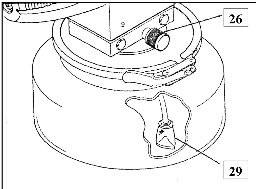
Распылите теплую воду после использования реагента, чтобы удалить возможные остатки реагента из трубопроводов генератора. При этом **регулятор потока (26) должен быть переведён в максимальное положение** (вращать регулятор против часовой стрелки до упора).
